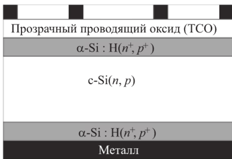
Рис. 4.25. Схематическое изображение СЭ на основе гетероструктуры \alpha -Si / c-Si / \alpha -Si
