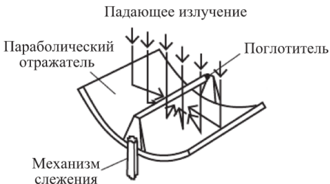
Рис. 4.37. Параболический коллектор-концентратор с одноосным слежением
