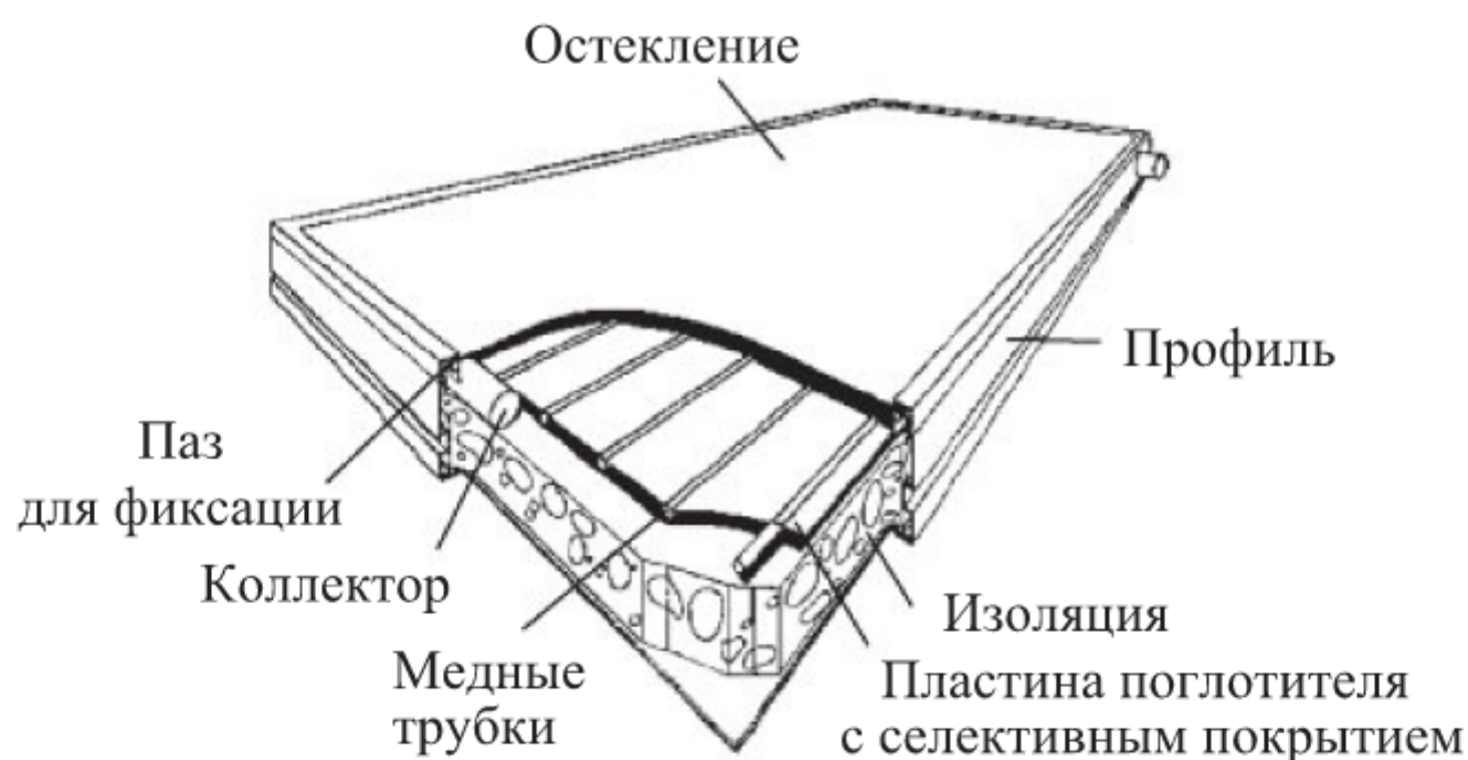
Рис. 4.34. Схема плоского солнечного коллектора
