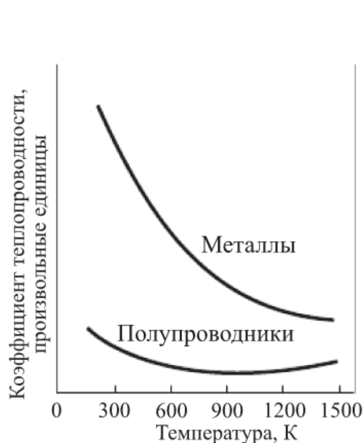
Рис. 4.48. Зависимость коэффициента теплопроводности от температуры для типичных полупроводников и металлов
