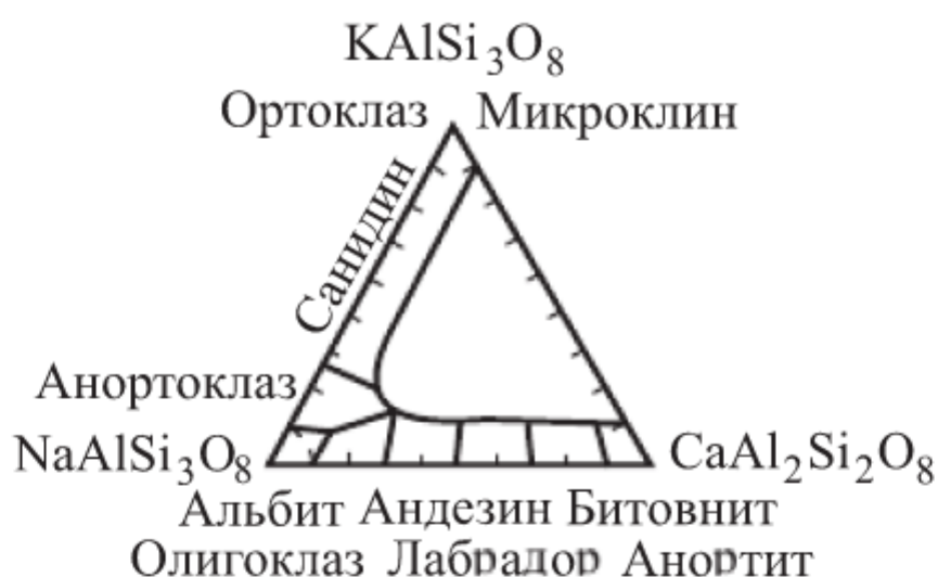
Рис. 3.6. Области существования твердых растворов полевых шпатов
