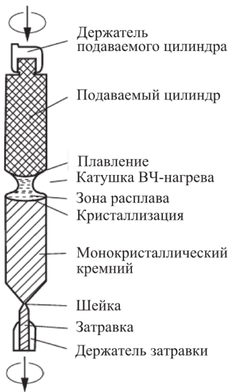
Рис. 4.11. Принцип получения монокристаллического кремния методом зонной плавки
