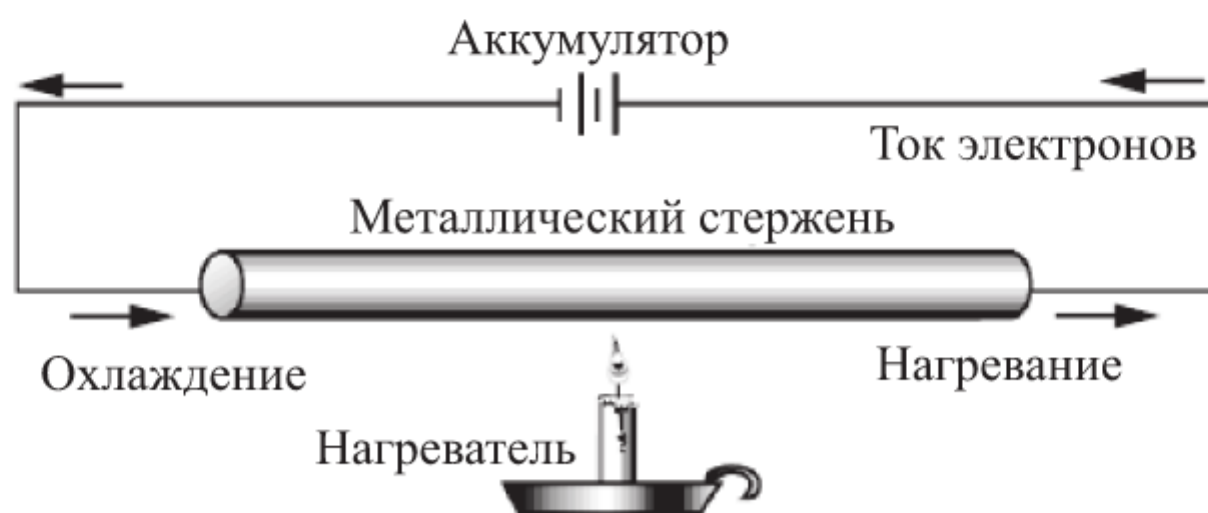
Рис. 4.41. Схема наблюдения эффекта Томсона
