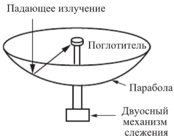
Рис. 4.38. Параболический коллектор-концентратор с двуосным слежением и точечным нагревателем
