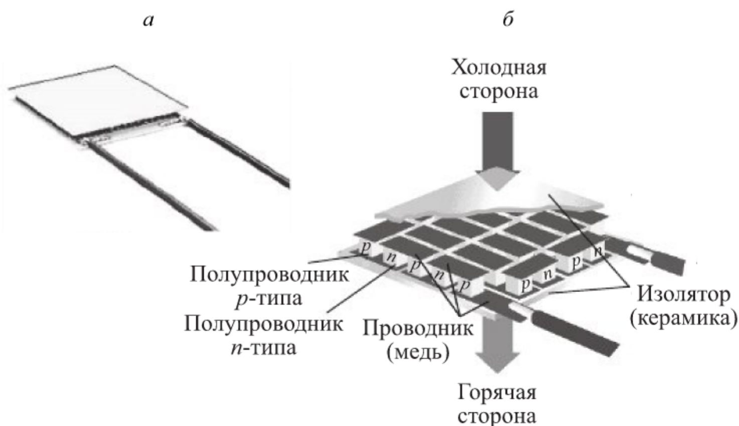
Рис. 4.56. Внешний вид (а) и принципиальная схема (б) модуля Пельтье
